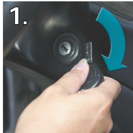
1. Motor abstellen, Bremse anziehen. Fremdbeheizung abstellen.
