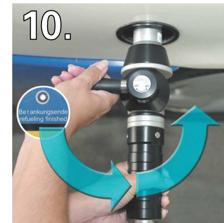
10. Erst wenn die weiße Lampe an der Zapfsäule leuchtet, den Bedienungshebel der Füllkupplung um 180° drehen (abkuppeln)
